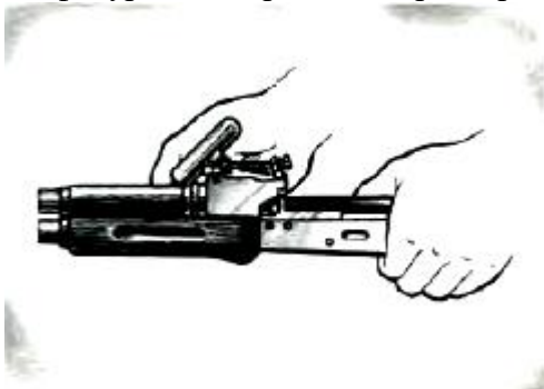
Поворот замыкателя газовой трубки
