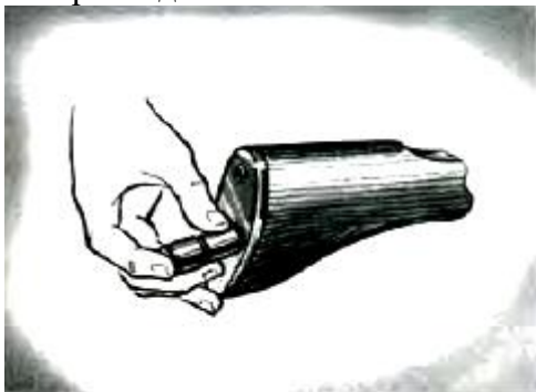
Вкладывание пенала в гнездо приклада
